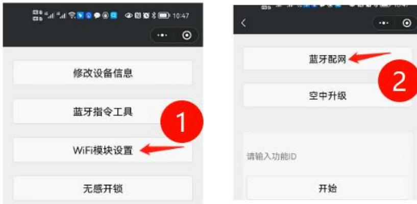
5、在蓝牙配网界面，出现多个 MAC 地址的设备，找到“过滤”，启用过滤设备名，输入“YESSYS”，点“确定”
