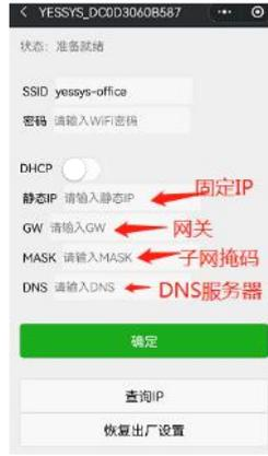
8、配置完成，在此界面的左上角会显示已发送，然后显示查询中，成功连接上网络后，会有弹框显示设备分配到的 IP 地址，同样屏幕上也会显示 WIFI 的信号强度，此时也说明配网成功
